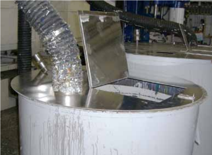
Abbildung 6: Deckel eines Ansatzbehälters mit Anschlussstutzen für eine Absaugung und Zugabeöffnung
