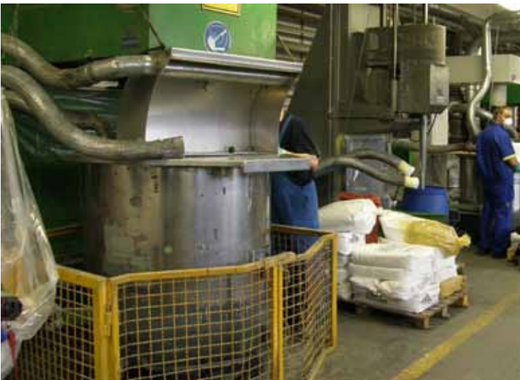
Abbildung 8: Wirbel-Drall-Erfassung für die Zugabe von festen Grundstoffen
