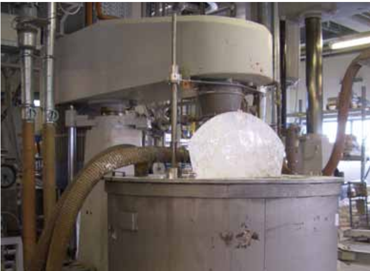
Abbildung 7: Deckel mit Zuschlagklappe und Absaugstutzen
