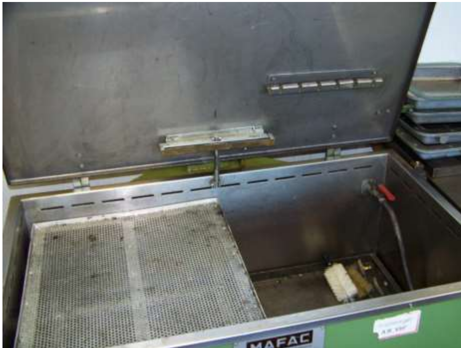
Abbildung 4: Beispiel für einen Teilewaschtisch mit Randabsaugung
